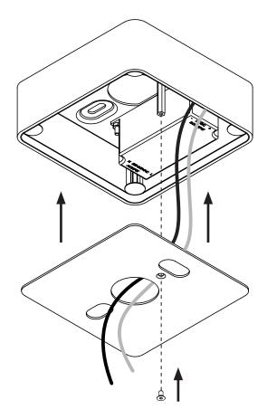
Nach erfolgter Verdrahtung werden die 24 V-Kabel durch die Frontplatte geführt und diese wieder an das Aufbaugehäuse montiert.
