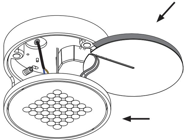
Die auf dem Blech befestigte Isolationsfolie an einer Seite leicht anheben zur besseren Kabeleinführung.
