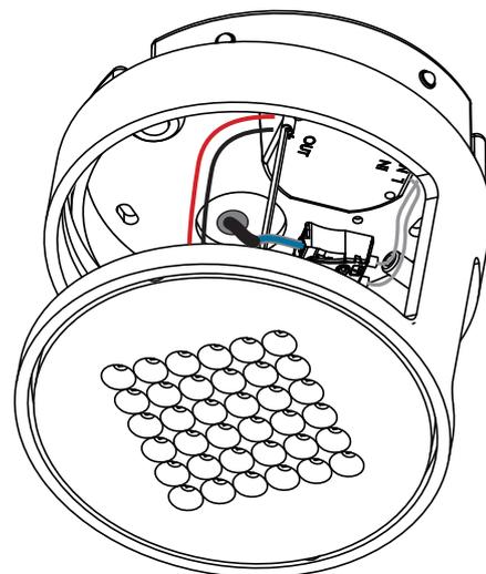
Zur Deinstallation der Leuchte die Madenschraube wieder lösen und das Rohr bis zum Anschlag drehen, dann abziehen.
