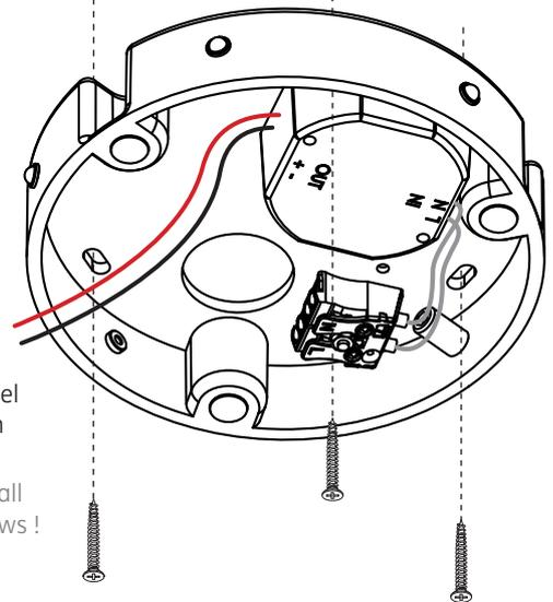
Geeignete Dübel und Schrauben verwenden !
