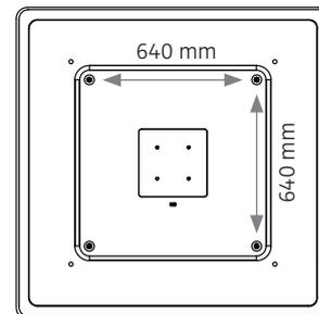
**ACHTUNG:** Schrauben und Beschläge entsprechend der Deckenbeschaffenheit und mit ausreichender Tragfähigkeit verwenden !
