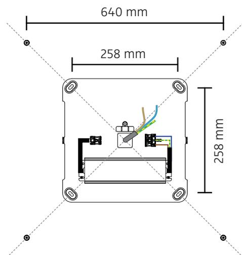
Deckenblech des Baldachins mittig montieren !
