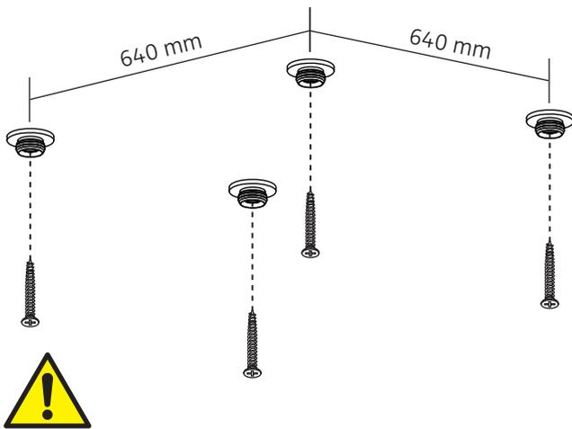
POSITIONIERUNG: Die Montagepunkte der Pendelseile definieren die exakte Position der Leuchte. Baldachin samt Deckenauslass sollten sich möglichst mittig zwischen den Pendelseilen befinden.
